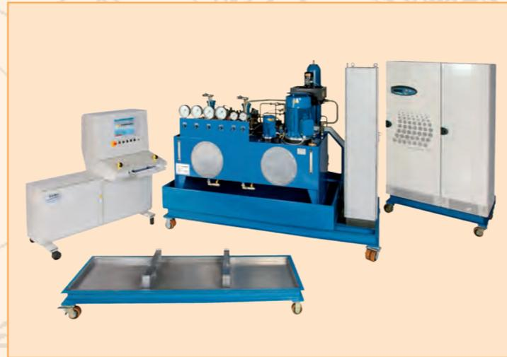
Beispiel: Prüfstandstechnik Schienenfahrzeuge
